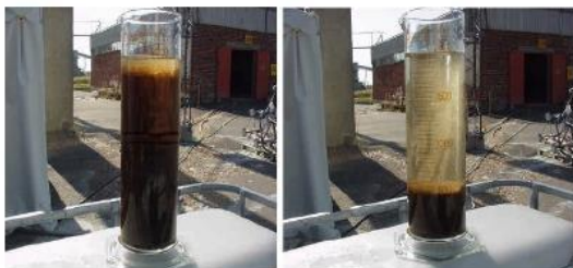
Decantação de Lodo de ETE
